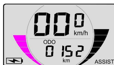
Poloviční stav nabití
