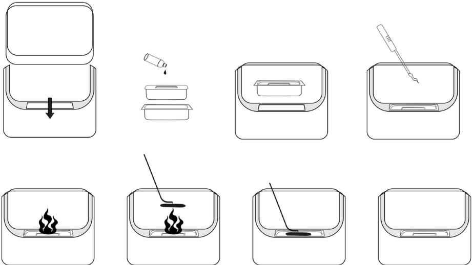
Die Feuerstelle erlischt, wenn der Brennstoff aufgebraucht ist. Wenn Sie das Feuer vorher löschen wollen, verwenden Sie den Flammenlöscher (Teil 5), um die Flamme zu ersticken.
