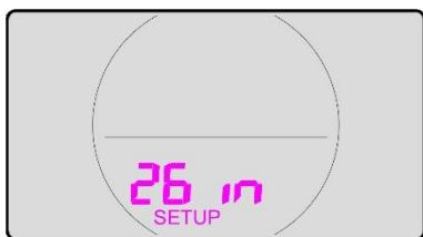
Po otevření nabídky se nacházíte v nastavení průměru plášťů.
