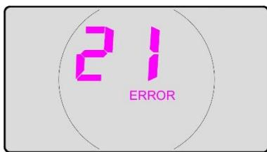
Vyskytne-li se problém s elektrickým pohonem, řídicí jednotkou nebo elektrickými komponenty, zobrazí se na displeji toto chybové hlášení. Oujeví-li se chybové hlášení, je nutné zkontrolovat příslušný systém nebo komponent.
