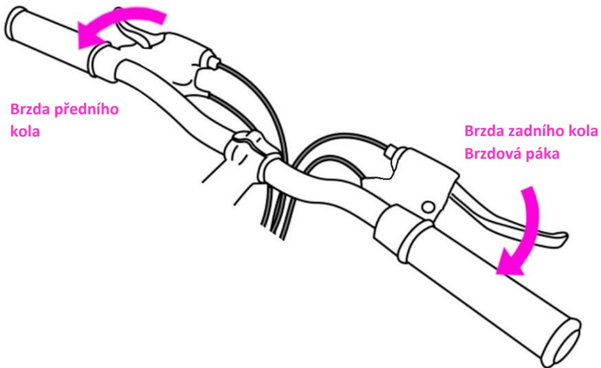
Brzdy jsou určeny k regulaci rychlosti, a nikoliv jen k prostému zastavení jízdního kola. Maximální brzdná síla pro brzdění kol je k dispozici krátce před „zablokováním“ (zastavením) kol a následným smykkem. Jakmile dojde k prokluzu pneumatiky, ztratíte většinu brzdné síly i veškerou kontrolu nad jízdním kolem. Musíte nacvičit postupné brzdění a zastavení bez zablokování kol. Této technice se říká progresivní modulace brzdového výkonu.
