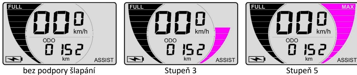
Pro zvýšení intenzity podpory šlapání stiskněte tlačítko **+** nebo tlačítko **-** pro její snížení. Lze zvolit stupeň od „0“ – žádná podpora šlapání až „5“ – maximální podpora šlapání.
